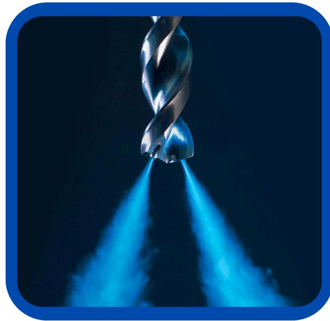
En la industria de precisión, cada micra cuenta. Los sistemas de **Mínima Cantidad de Lubricante (MQL)** están diseñados para optimizar la lubricación, reducir el desgaste y mejorar la eficiencia operativa. Sin embargo, un sistema MQL sin calibración regular compromete la calidad del maquinado, aumenta el consumo de insumos y genera daño al medio ambiente. Imagina que un mal ajuste en el sistema de lubricación provoca una falla en una de tus máquinas clave en medio de una producción crítica.
